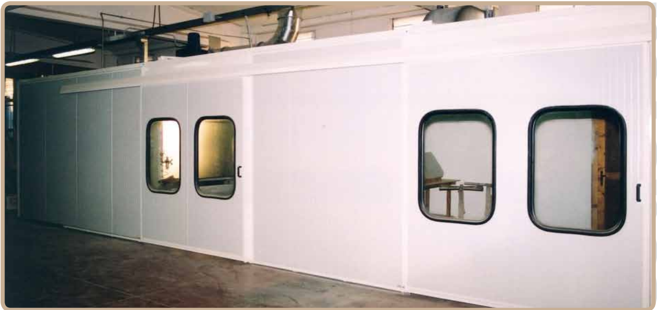
Figura 25: Cabina di verniciatura pressurizzata con essiccoio.
