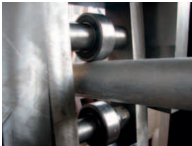
Figura 4.1-2 Accessorio per il trasferimento dello spostamento della traversa della macchina di prova al traverso del dispositivo di collegamento sottoposto a prova
