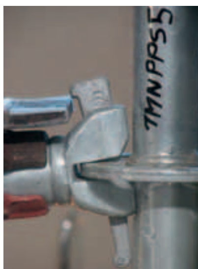
Figura 4.2.1.8-5: Imbozzamento del montante (evento b)
