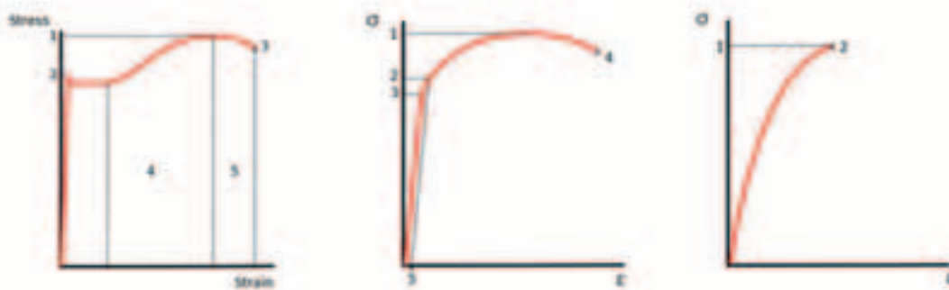
Curva tensione-deformazione di materiali duttili
