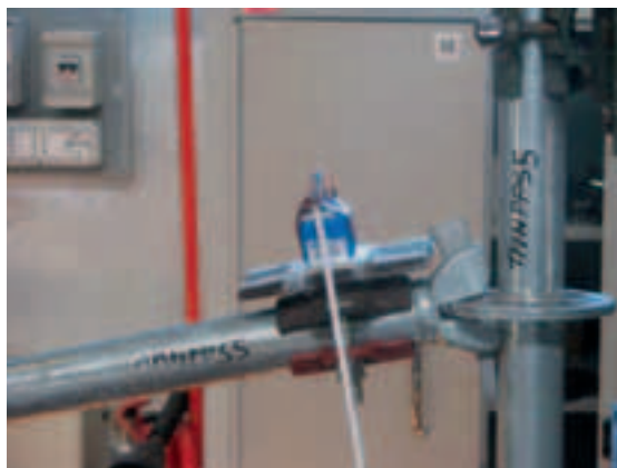
Figura 4.2.1.8-6: Contatto cuneo montante (evento c)
