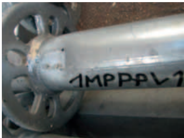
Figura 4.2.2.1-3: Fine prova Deformazione permanente del montante al contatto con la forchetta – dettaglio 1
