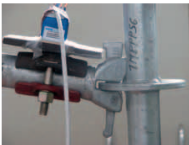
Figura 4.2.2.8-7: Deformazione al 21° minuto di prova –evidente imbozzamento del montante
