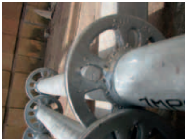
Figura 4.2.2.2-9: Fine prova - Deformazione permanente (ovalizzazione) del foro della rosetta
