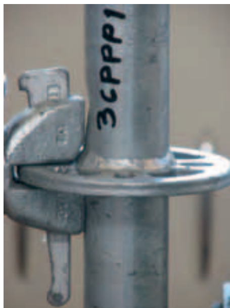
Figura 4.2.6-22: Fine prova allo scarico della traversa
