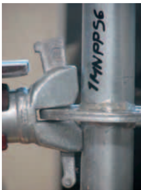
Figura 4.2.1.9-7: Deformazione al 18° minuto (primo massimo locale M L ) - dettaglio
