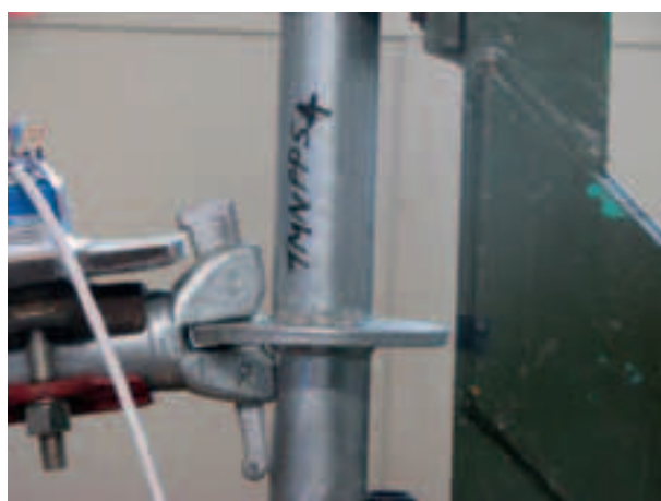
Figura 4.2.1.7-8: Deformazione del sistema oltre il contatto cuneo-montante
