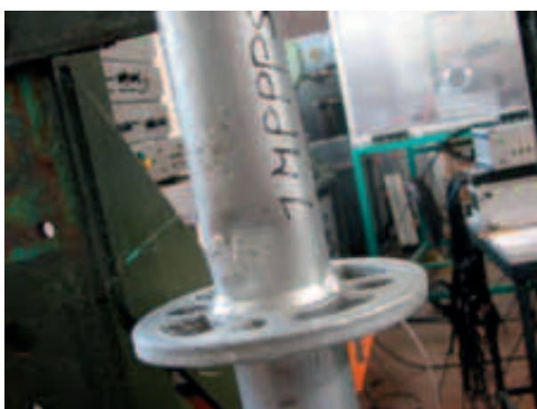
Figura 4.2.2.3-7: Fine prova - Deformazione permanente del montante al contatto con la forchetta dettaglio 2
