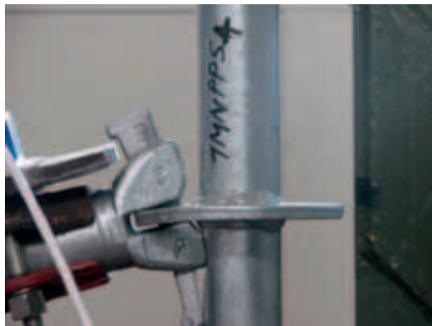
Figura 4.2.1.7-11: Deformazione del sistema oltre il contatto cuneo-montante
