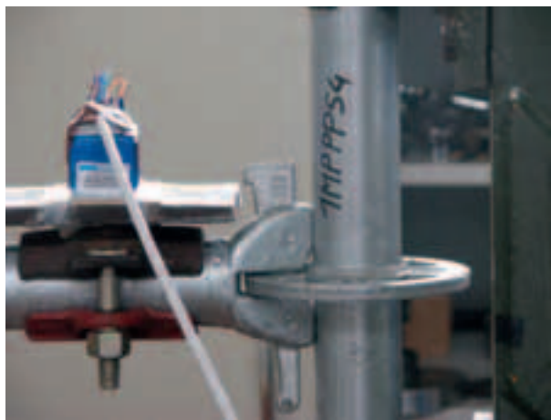
Figura 4.2.2.6-4: Formarsi di aria al contatto tra il montante e la forchetta del traverso (evento a)
