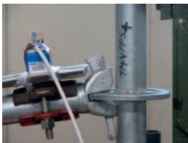
Figura 4.2.1.7-7: Contatto cuneo montante (evento c)
