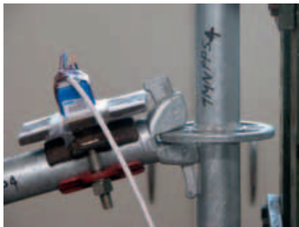
Figura 4.2.1.7-10: Deformazione del sistema oltre il contatto cuneo-montante
