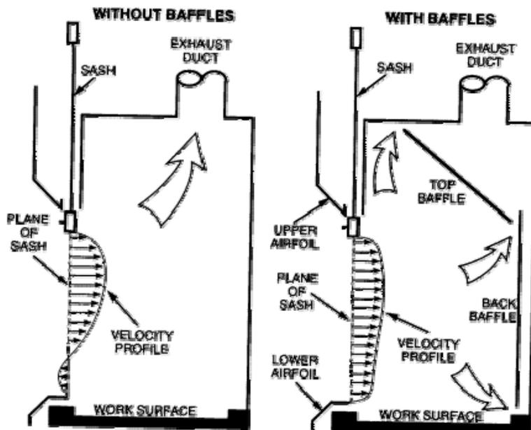
I punti di aspirazione all'interno della cappa sono ubicati preferibilmente a diverse altezze sul pannello di fondo. Questa scelta tecnica fa sì che in corrispondenza di tali fessure la velocità di aspirazione sia alta (a parità di portata viene ridotta l'area superficiale) mentre la diversa altezza
