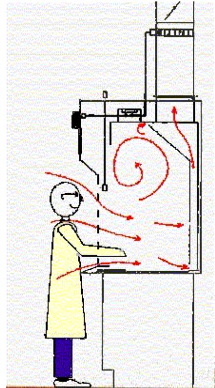
aspirazione. Il vetro frontale è normalmente a saliscendi con contrappesi, i vetri sono di solito in cristallo temperato o di sicurezza oppure in policarbonato in caso di utilizzo di acido fluoridrico. Il piano di lavoro può essere in grès monolitico, polipropilene, acciaio o resina epossidica, in un pezzo unico, con bordi antisversamento arrotondati in modo da garantire una maggiore
