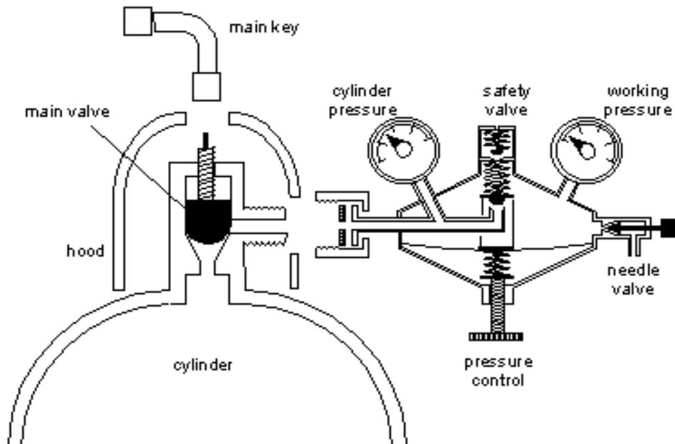
Agendo sulla manopola di regolazione della pressione, si comprime la molla superiore che spingendo il diaframma muove lo stelo che apre la valvola riduttrice. Una piccola quantità di gas fluisce dalla camera ad alta pressione a quella a bassa pressione, il gas spinge sul diaframma e quando la sua forza supera il carico della molla superiore (che sarà uguale alla pressione in uscita dal riduttore), il diaframma si muove in senso contrario e chiude la valvola riduttrice.
