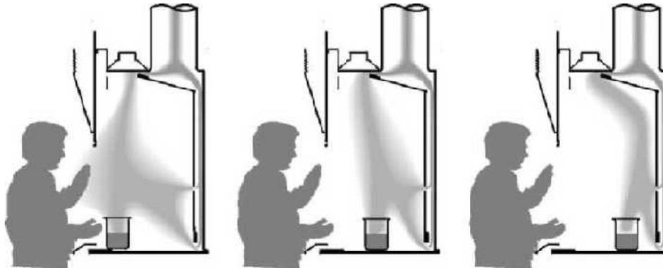
15. Evitare di creare delle correnti d'aria in prossimità di una cappa in funzione (apertura di porte o finestre, transito frequente di persone).
