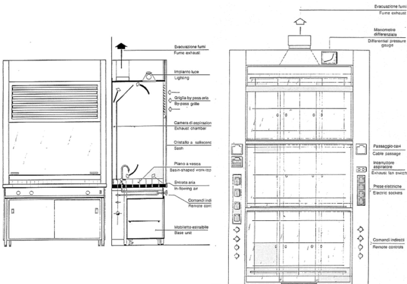
Le **cappe tecnologiche** per gli impianti pilota sono senza piano di lavoro, permettendo di utilizzare come vano cappa tutta l'altezza disponibile della struttura a partire dal pavimento; sono celle praticabili per le operazioni di montaggio dell'apparecchiatura e l'avviamento delle reazioni.
