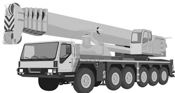
**Autogru:** gru a braccio autonomo in grado di spostarsi con o senza carico senza la necessità di vie di corsa fisse e che si basa sulla gravità per la stabilità. Tali gru possono funzionare su pneumatici, cingoli o altri mezzi mobili. In posizioni fisse possono essere sostenute da stabilizzatori o altri accessori che ne aumentano la stabilità [EN 13000].
