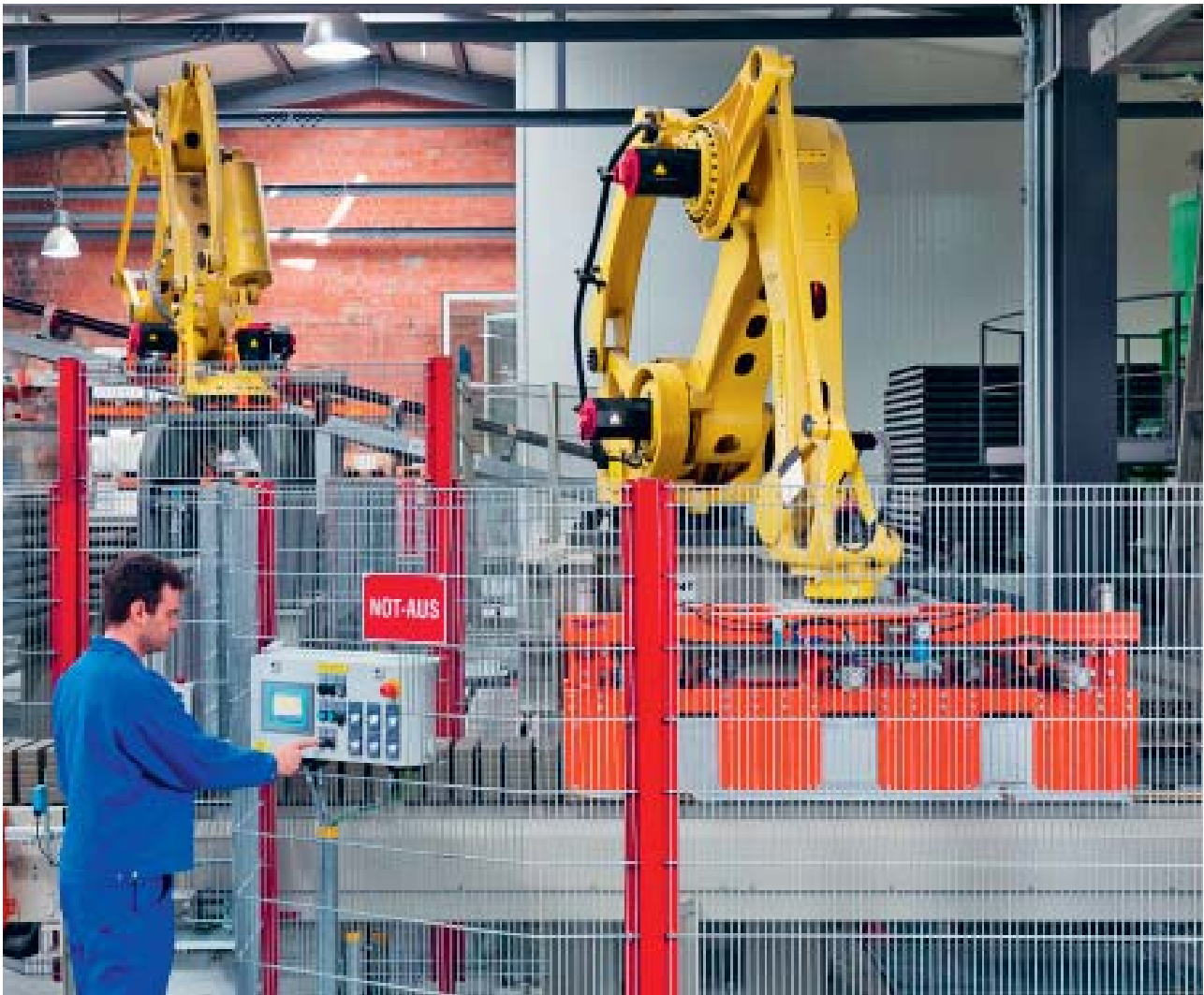
Fig. 1 Impianto automatico di produzione di mattoni: nei moderni impianti di produzione la sorveglianza di più macchine è affidata spesso a una persona che lavora da sola in un capannone.
