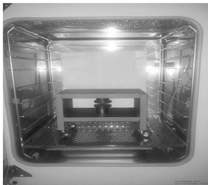
**Figura 2** - Sistema di esposizione a campi magnetici statici per colture cellulari in vitro
