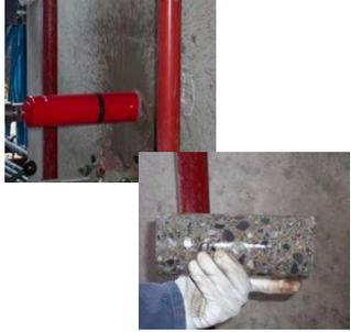
Viene estratto un campione di cls in opera e successivamente viene sottoposto a prova di schiacciamento per determinare la classe
