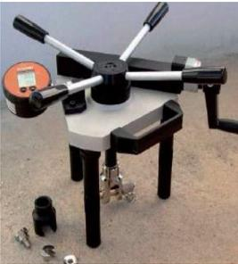
La prova di estrazione è eseguita in opera mediante un martinetto idraulico, consente di determinare la resistenza di un ancoraggio analogo a quello che verrà utilizzato nella progettazione. E' quindi la prova preferibile per la progettazione.
