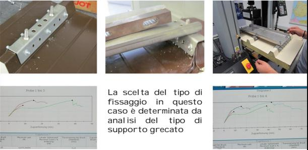
La scelta del tipo di fissaggio in questo caso è determinata da analisi del tipo di supporto grecato
