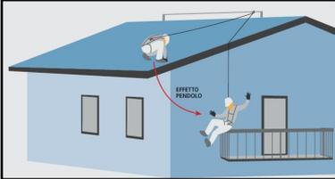
Tenere in considerazione la possibilità che le caratteristiche della corda si riducano a causa del continuo sfregamento lungo i bordi della copertura prima del raggiungimento della posizione di equilibrio
