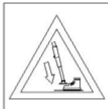
Per le macchine con elemento di estensione a pantografo valutare il rischio di schiacciamento delle mani. Posizionare la macchina solo su una superficie stabile.
