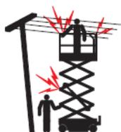
Nell'esecuzione dei lavori in PLE devono essere mantenute le distanze di sicurezza da parti elettriche attive indicate nella Tabella 1 (Allegato IX del D.Lgs. 81/2008). Qualora sia necessario operare a una **distanza** dalle parti attive in tensione accessibili di impianti o linee elettriche **inferiore** a quella di sicurezza indicata in Tabella 1,
