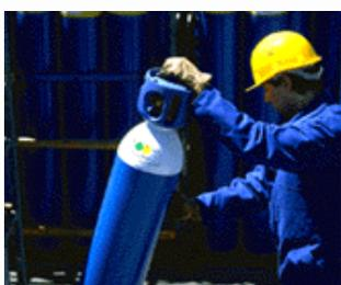
L'ossigeno si trova nell'aria ad un tenore del 21% circa. E' un gas comburente incolore, inodoro e insapore. Il sistema di conservazione e trasporto avviene in bombole la cui pressione massima è di 200 kg/cm<sup>2</sup>.
