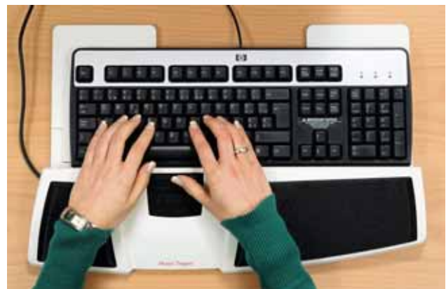
Figura 17: Questo mouse speciale si trova davanti alla tastiera e si utilizza con entrambi i pollici.
