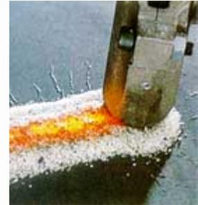
Nuove e più sofisticate tecniche di saldatura automatica si sono aggiunte come, per esempio, il procedimento **TIG a quattro elettrodi e ad arco sommerso con tre fili**. Questi consentono di accelerare notevolmente la velocità di saldatura e sono utilizzati in particolare modo nella grossa carpenteria e nella produzione di tubi saldati.
