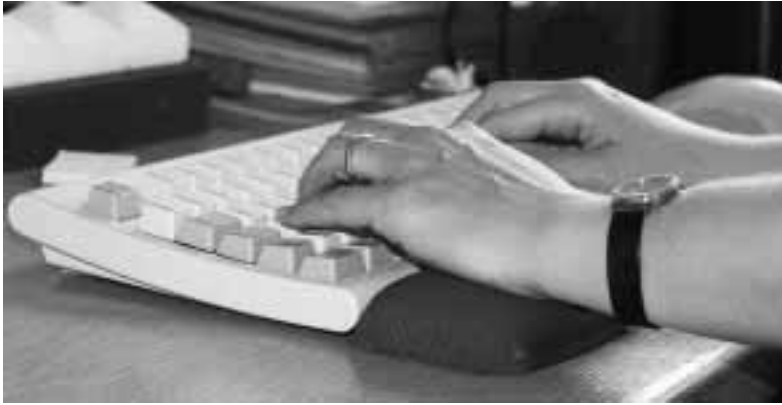
Figure 55, 56 Posizione della tastiera sul piano di lavoro senza (fig. 55) e con poggiapolsi (fig. 56)
