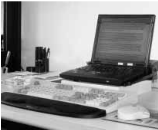
Figura 36 Notebook in una postazione fissa collegato ad una docking station con tastiera e mouse esterni
