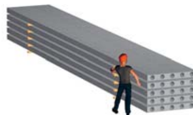
3 Cautela in presenza di appoggi temporanei: evitare il ribaltamento di travi!
