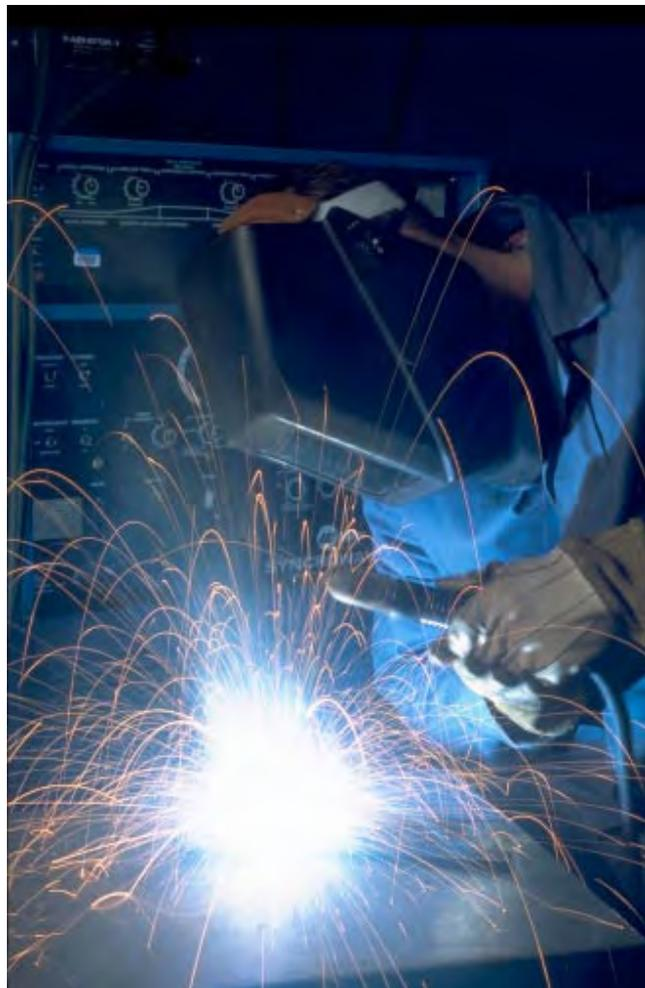
**Figura 1- Saldatura manuale ad arco con elettrodi rivestiti**
