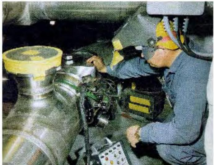
**Figura 12- - Applicazioni manuale ed automatica del processo TIG.**
