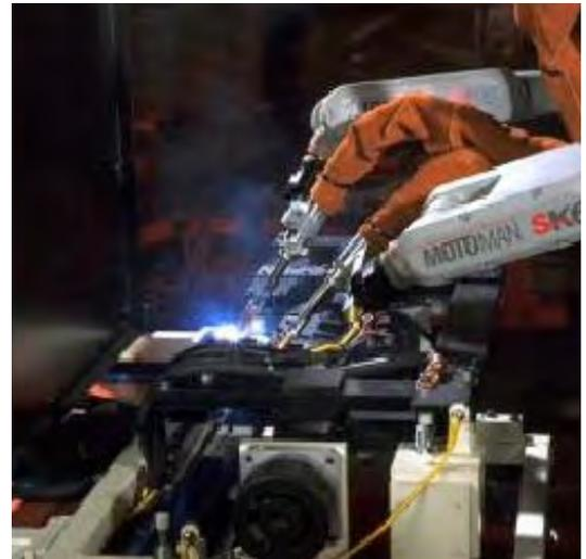
**Figura 10 - Applicazioni robotizzate della saldatura GMAW.**
