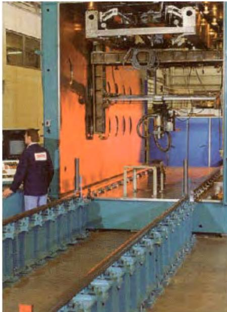
**Figura 13- - Camera per la saldatura a fascio elettronico (sotto vuoto)**
