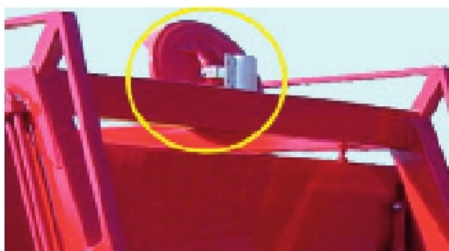
Figura 15. Esempi applicativi di specchi (evidenziati in figura) installati sulla struttura portante dei bracci dell'organo di taglio (fresa)
