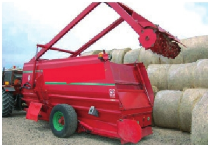
Figura20. Organi di taglio e di carico in posizione sollevata; parete mobile in posizione abbassata e organi di miscelazione e/o trinciatura in movimento protetti
