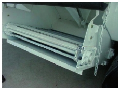
Figura21. Esempi di protezione applicata al nastro trasportatore
