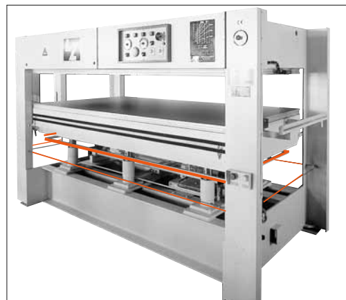
Foto 3: il bordo sensibile alla pressione o la fune a strappo impedisce che l'operatore rimanga schiacciato sotto il banco.
