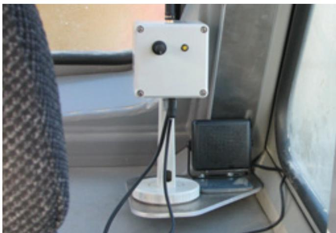
Figure 15 – Exemple d'implantation d'un détecteur sur un tombereau rigide (balise ci-dessus, avertisseur sonore ci-contre)
