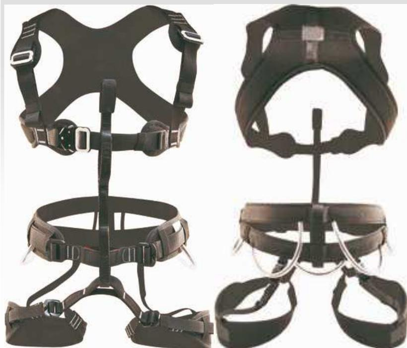
figura 1 Esempio di Imbracatura per il corpo con attacco sulla schiena per l'arresto caduta e attacco per il posizionamento sul lavoro
