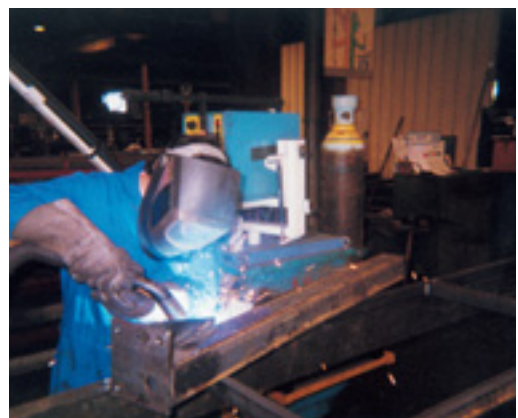
Photo 5.9. Système de torche de soudage avec aspiration intégrée.
