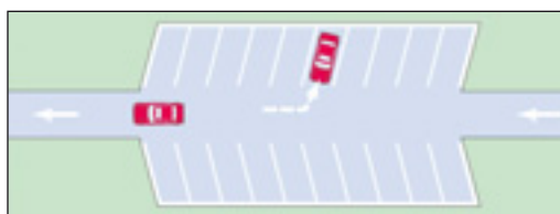
Figure 4.4.c. Entrée marche arrière, sortie marche avant.
