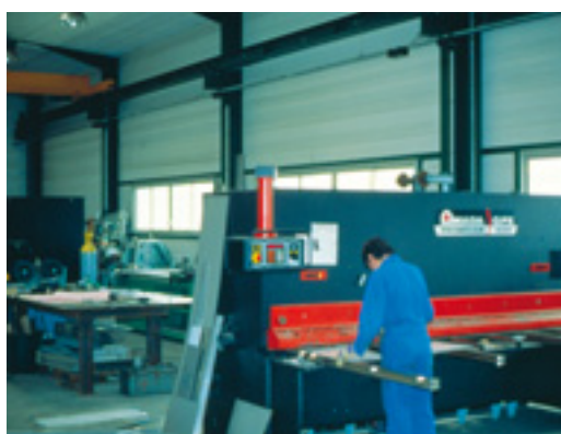
Photo 7.5. Éclairage de la situation de travail par des baies vitrées latérales offrant la vue sur l'extérieur.
