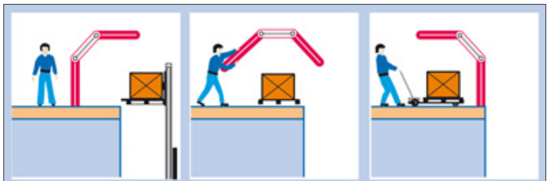
Figure 8.3. Principe de fonctionnement d'une barrière écluse.
