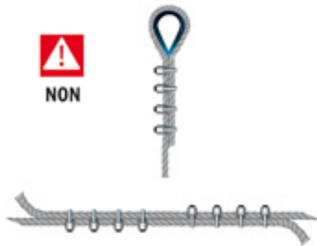
Figure 8 - Assemblages avec serre-câbles
