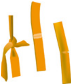
Figure 37 - Principaux défauts présents sur une sangle de levage
