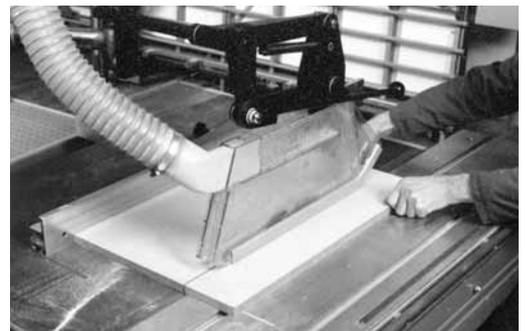
Fig. 9: collettore di aspirazione nella cuffia di protezione.
