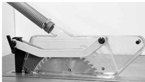
Fig. 3: cuffia di protezione montata sul cuneo fenditore.
