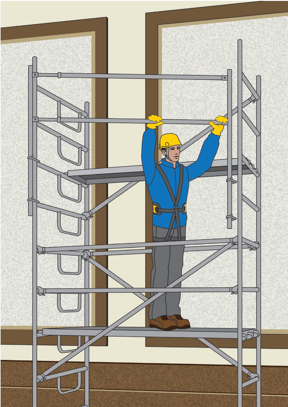
Figura 4 - Trabattello con montaggio dal basso
