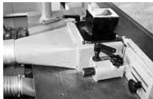
Fig. 3: schermatura (cassa protettiva) a protezione contro il contatto con l'utensile dietro la guida e per trattenere la polvere e i trucioli. La parte superiore è ribaltabile in modo da consentire la sostituzione dell'utensile senza dover smontare la cassa protettiva.
