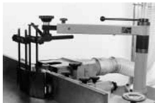
Fig. 5: protettore-premipezzo Suva per la sagomatura alla guida.
