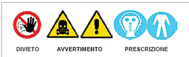
Figura 4 - Esempi di segnalazione di aree a rischio
