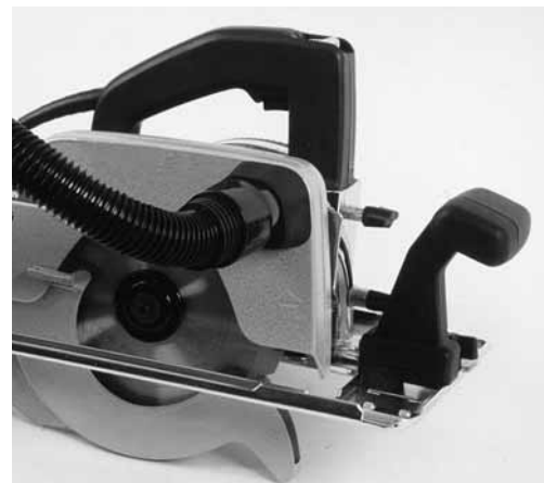
Figura 4: sega circolare portatile allacciata all'aspiratore.
