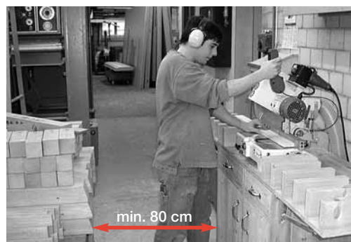
Foto 2: per lavorare in condizioni di sicurezza l'operatore deve disporre di almeno 80 cm di spazio per muoversi liberamente attorno alla macchina.
