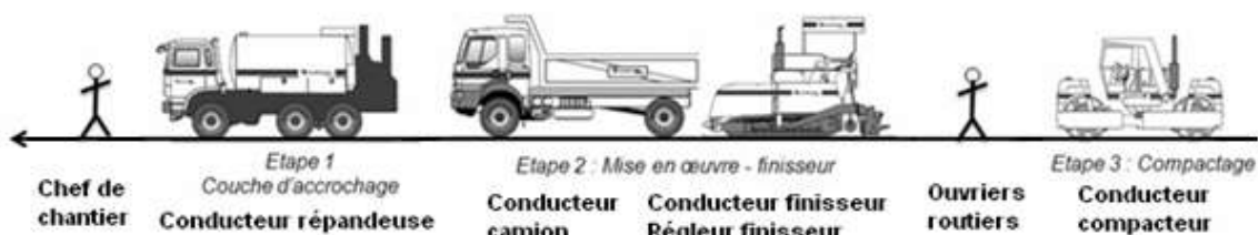
Figure 27 : Mise en œuvre d'un enrobé à chaud (d'après audition USIRF, 2011)
