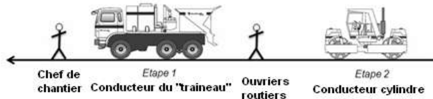
Figure 28 : Mise en œuvre des enrobés coulés à froid (d'après audition USIRF, 2011)
