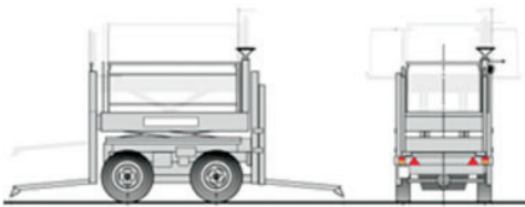
Esempio di macchina agricola raccogli frutta con piattaforma e comandi singoli
