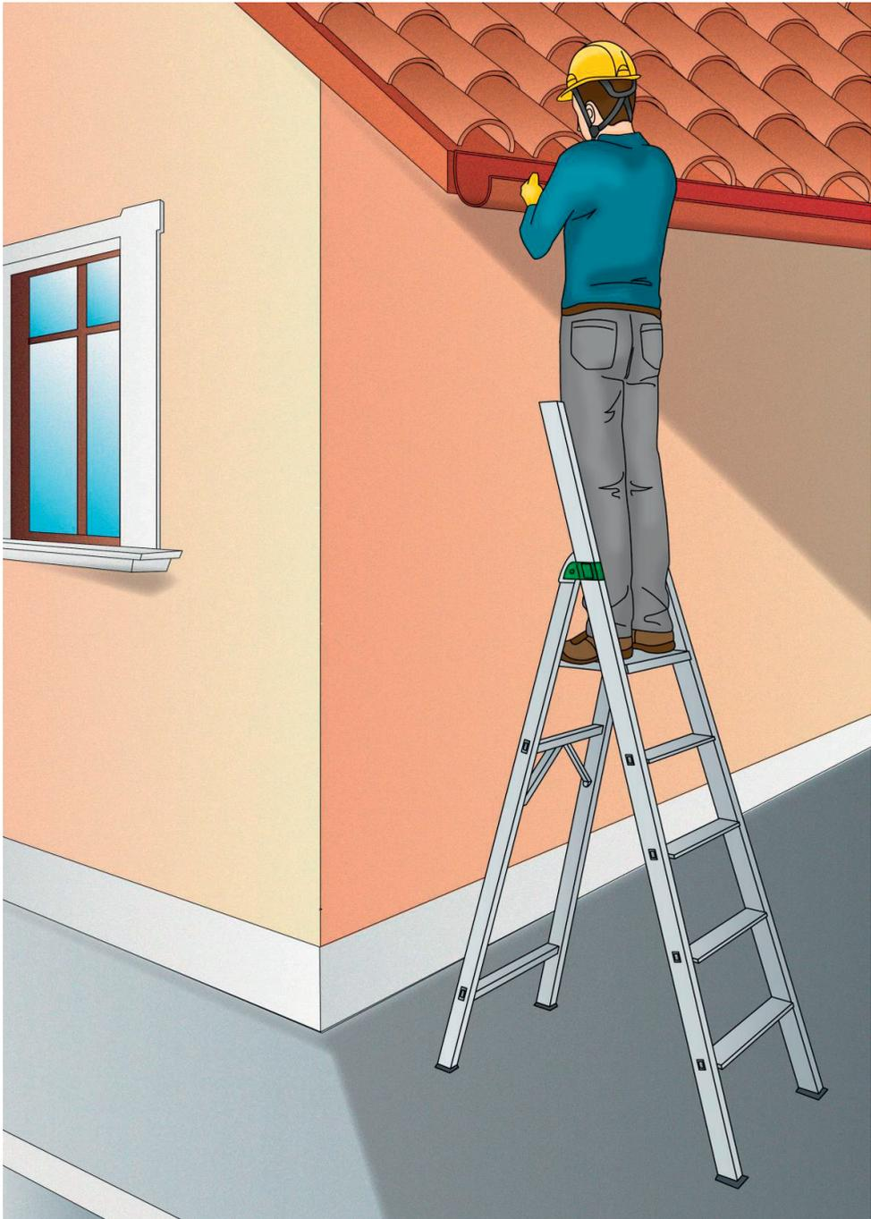
Figura 4 - Esempio di scala doppia
