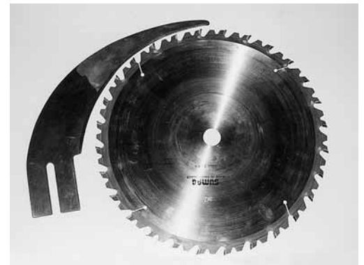
Figura 6: cuneo fenditore che supera la sporgenza massima della dentatura della lama circolare. Questo cuneo fenditore offre una maggiore sicurezza contro il contatto con la lama quando quest'ultima esce dal piano di lavoro della macchina. Questi cunei fenditori speciali sono da ordinare presso il costruttore della macchina. È bene comunque preferire una cuffia di protezione di tipo fisso.
