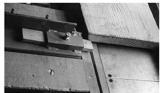
Figura 8: guida trasversale provvista di inserti di legno sul lato di lavoro dell'operatore.
