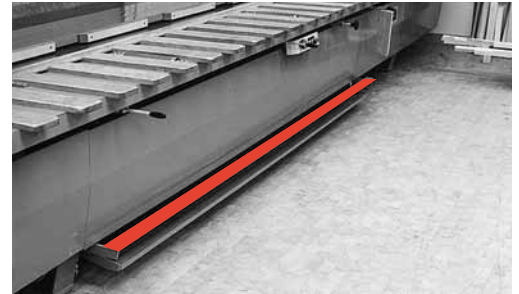
Figura 1: la copertura della barra d'azionamento del comando a pedale impedisce l'avviamento accidentale della lama circolare.
