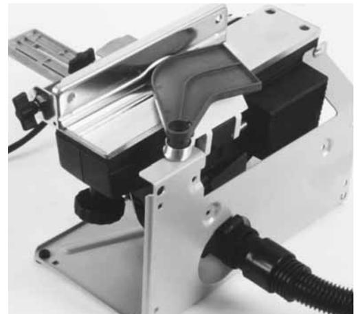
Pialla portatile usata in posizione stazionaria, equipaggiata con schermatura dell'albero portacoltelli e con basamento portapiaila.
