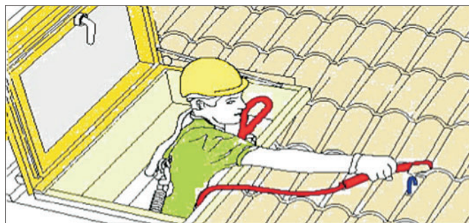
Figura 8 - Esempio di ancoraggio puntuale di accesso.
