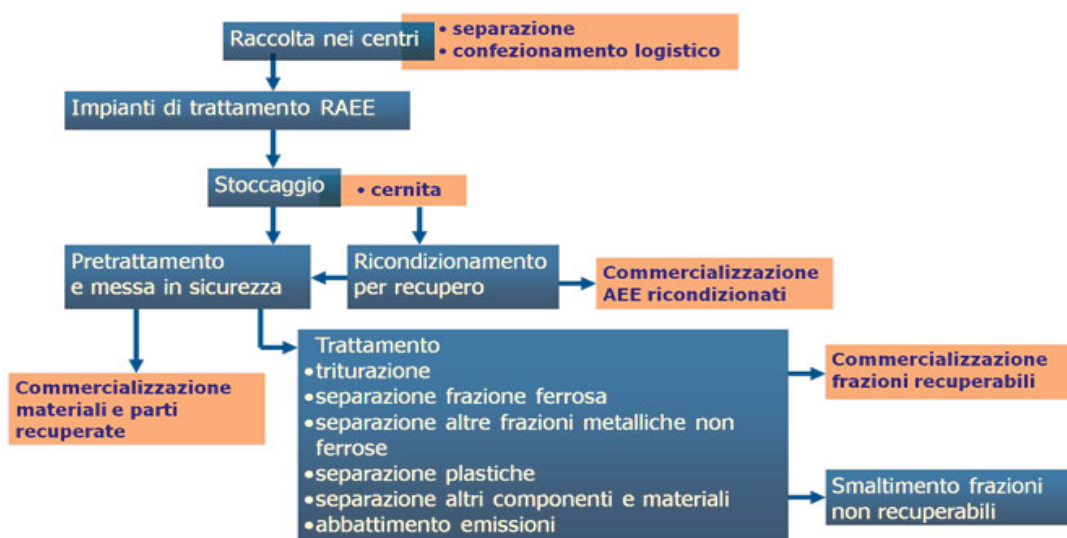
Fig. 17 - Schema a blocchi del ciclo di trattamento integrale dei RAEE
