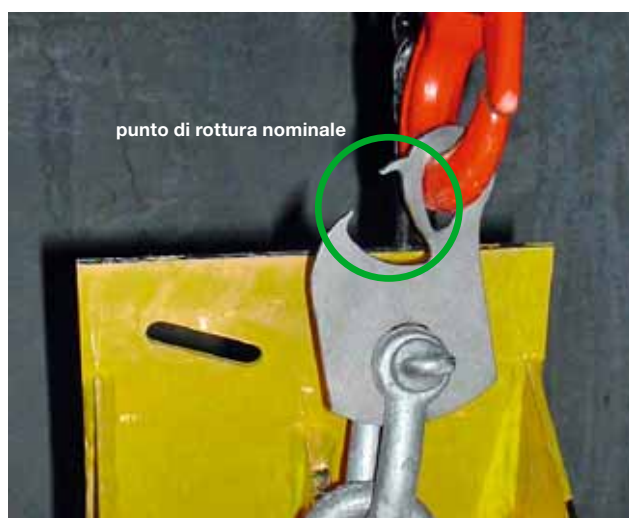
21 Verificare la portata dei punti di aggancio e ancoraggio: dispositivo di prova con punto di rottura nominale definito.
