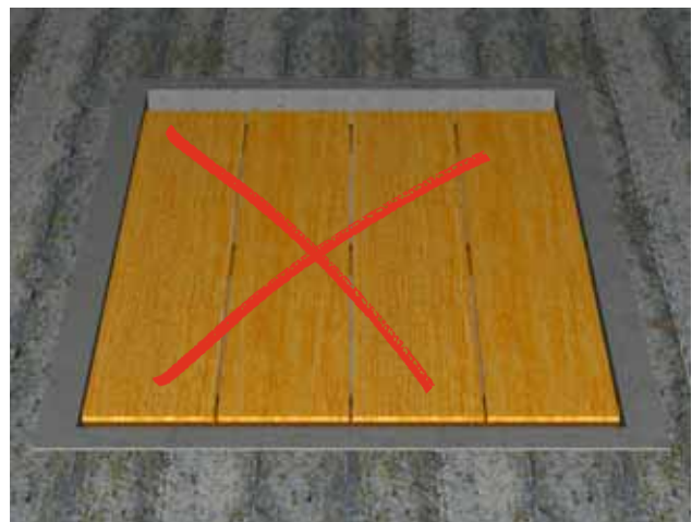
3 I pannelli di cassetta sono spesso causa di infortunio. Non devono mai essere impiegati per i piani di calpestio.
