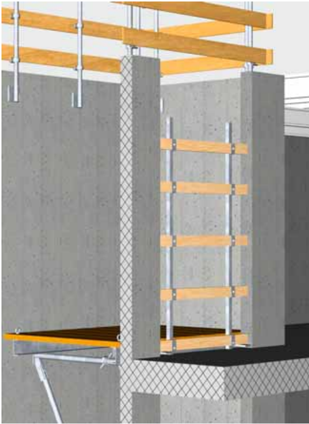
24 a Protezione laterale introdotta nell'elemento ad angolo di fissaggio nella soletta
