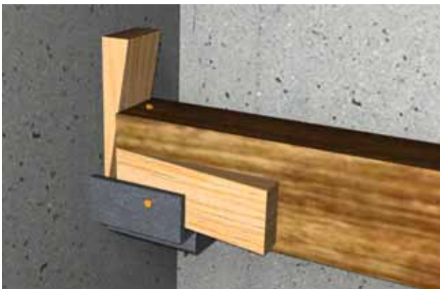
11 Per evitare il ribaltamento le travi devono essere assicurate con dei cunei.
