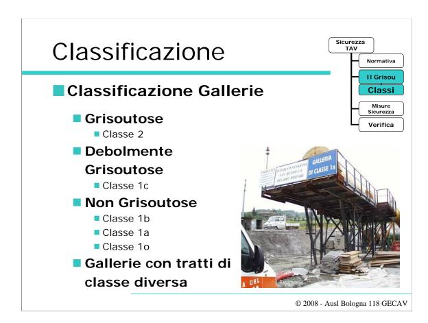
Le gallerie sono considerate **Grisoutose** e quindi di **Classe 2**, se l'analisi storica ed i dati attualmente disponibili indicano che esiste la probabilità di venute significative in corrispondenza di alcune strutture geologiche a grande scala (es. sinclinali, fasce di intensa fratturazione in corrispondenza delle zone di accavallamento tettonico)
