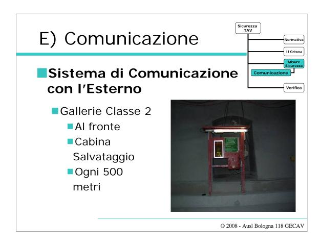
Considerando l'importanza assoluta della **comunicazione via cavo** all'interno delle Gallerie in fase di Costruzione (i cellulari e radio non ricevono il segnale), è indispensabile posizionare impianti telefonici:
