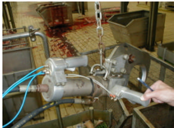
Foto n. 7/B: tranciatrice oleodinamica assistita pneumaticamente
