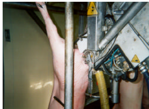
Foto n. 7/S: particolare robot tagliagentile
