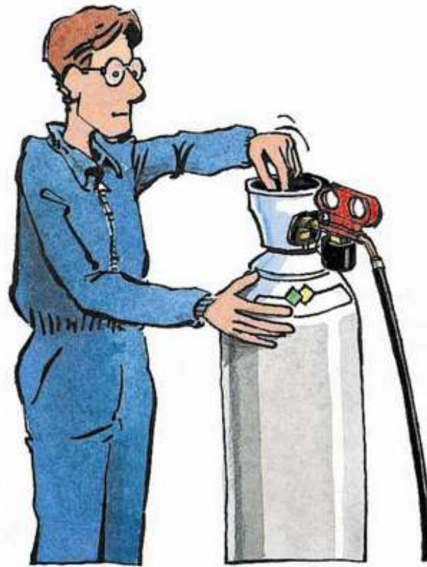
Kada se otvara ventil ili se radi na reduktoru, učinite to polako i postavite se na mjestu suprotnom od smjera izlaska plina!!!
