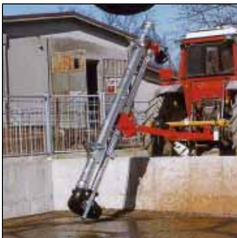
Figura 77 - Miscelatore in fase di immersione
