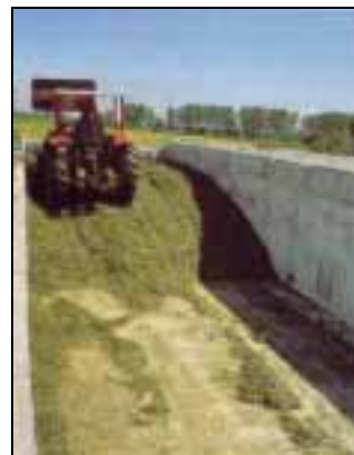
Figura 41 – Fase di compressione di un silo orizzontale mediante trattore con pala frontale
