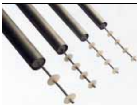
Figura 88 – Alcuni esempi di funi e tubazioni di trasporto per alimento secco
