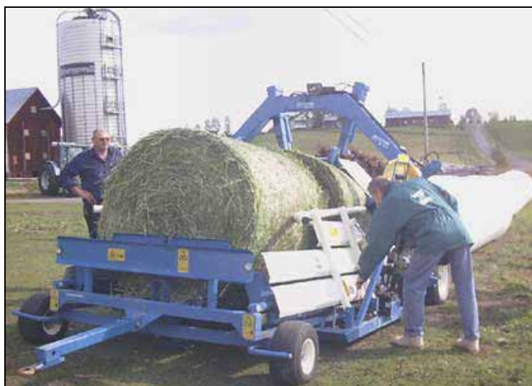
Figura 46 – Macchina formatrice di silo tubolare per l'insilamento delle rotoballe
