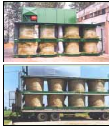
Figura 32 – Struttura mobile per essiccazione rotoballe in fase di lavoro e in fase di trasporto
