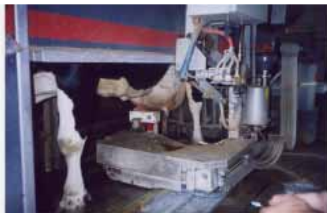
Impianto automatico di mungitura
