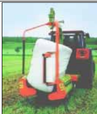
Figura 43 – Fasciatura delle big balers con film plastico
