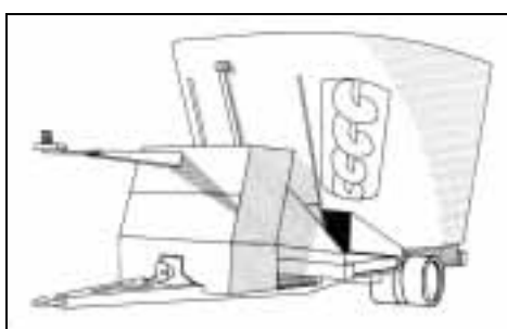
Figura 61 – Carro trinciamiscelatore a coclea verticale
