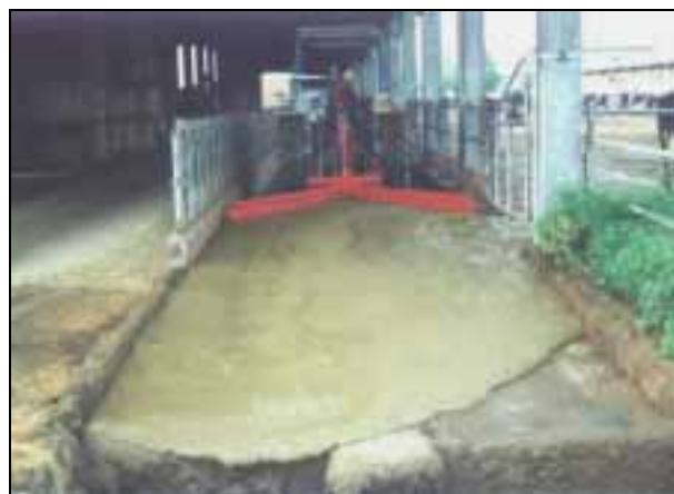
Figura 68 – Ruspetta applicata alla trattrice in fase di pulizia della zona di alimentazione
