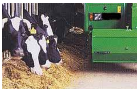
Figura 64 – Carro miscelatore semovente durante la fase di somministrazione dell'alimento
