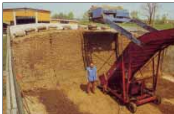
Figura 58 – Testata desilatrice con nastro elevatore.
