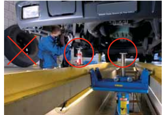
❷ Stoccaggio corretto e sostegno sicuro.
