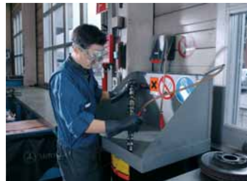
⑨ Installazione per la pulizia di piccoli pezzi: usare i dispositivi di protezione individuale.
