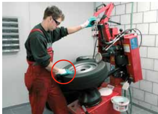
4 Macchina per il montaggio dei pneumatici: pericolo di schiacciamento.
