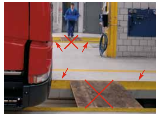
2 Non lasciare aperte le fosse che si trovano nelle zone di passaggio.
