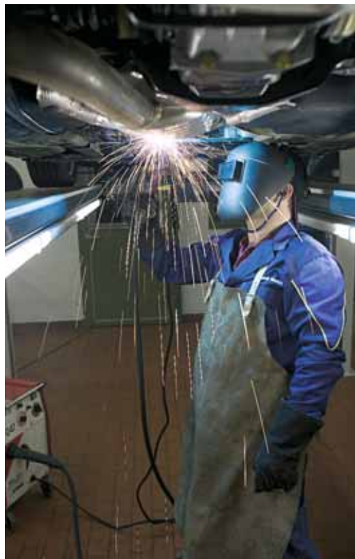
11 Saldatura con equipaggiamento di protezione.
