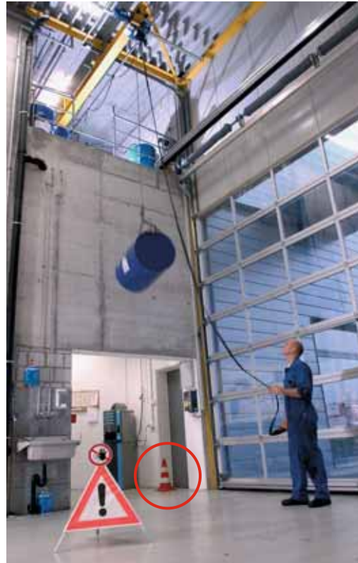
❶ Segnalare la zona di pericolo, vietare l'accesso.
