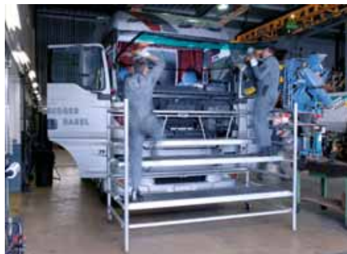
2 Usare una piattaforma sicura al posto delle scale.
