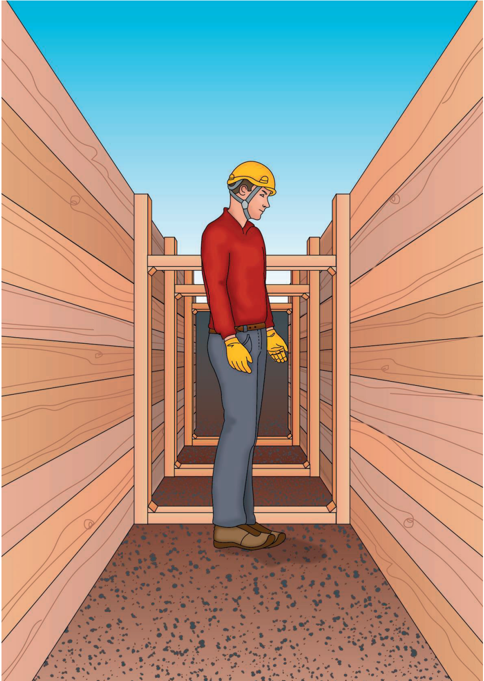
Figura 1 - Sistema realizzato totalmente in legno
