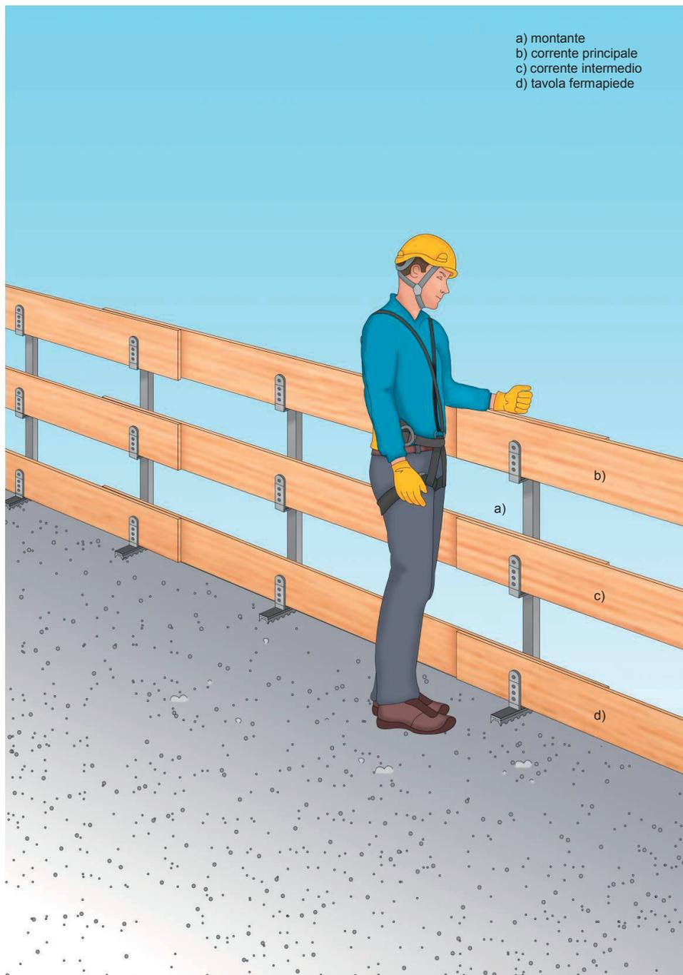
Figura 1 - Elementi costituenti il parapetto provvisorio
