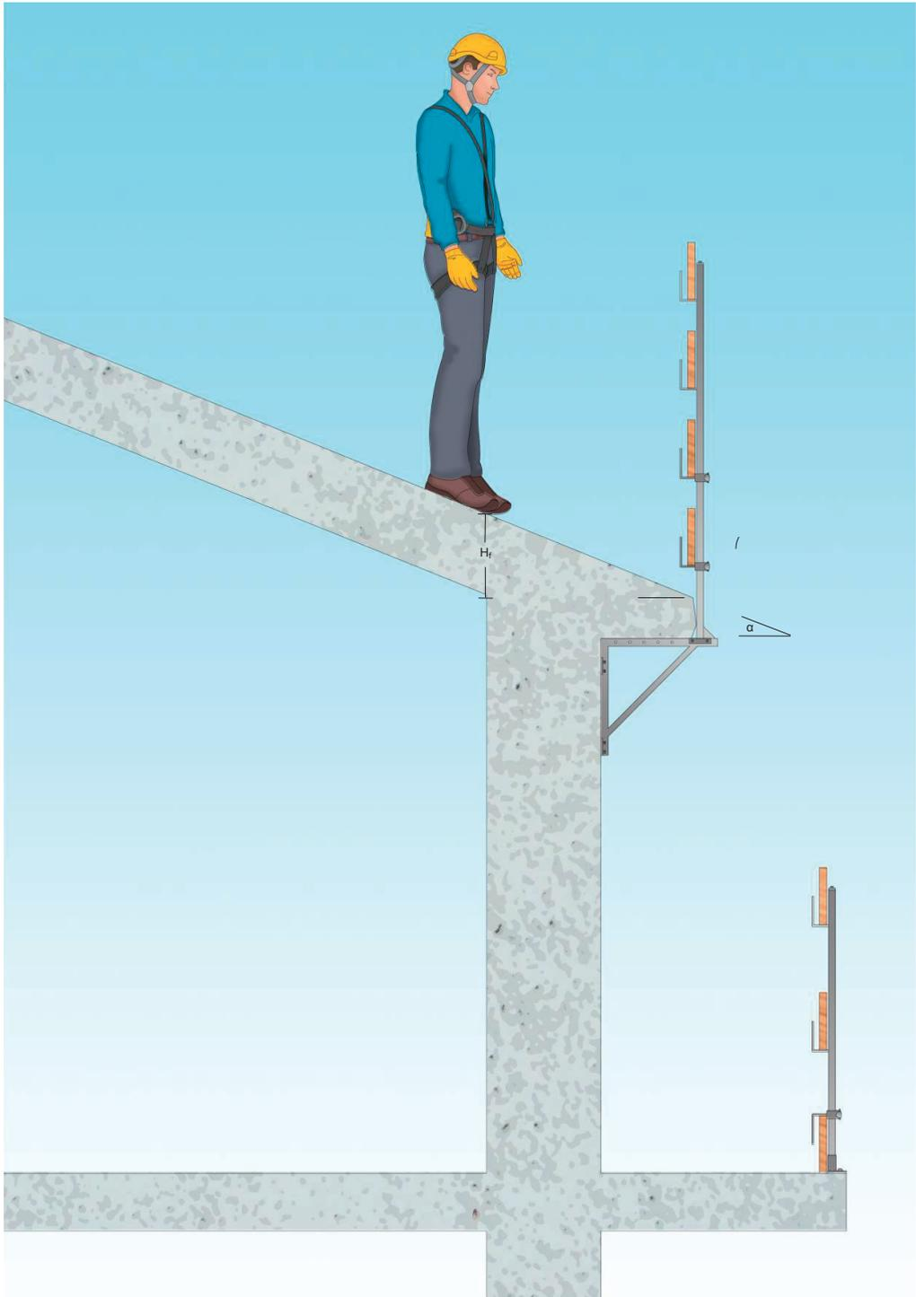
Figura 4 - Parapetti provvisori divisi per classi di utilizzo
