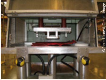
Figure 1. Exemple de blindage d'une soudeuse « haute fréquence »
