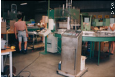
Figure 4. Exemples de carrousel sur une soudeuse « haute fréquence » et de table de transfert sur un banc de magnétoscopie
