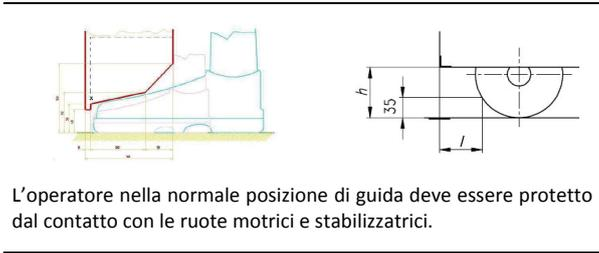
L'operatore nella normale posizione di guida deve essere protetto dal contatto con le ruote motrici e stabilizzatrici.
