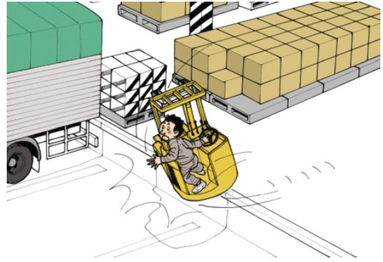
La banchina di carico deve essere protetta con parapetti normali (amovibili nella zona di raccordo con il veicolo) al fine di evitare le cadute accidentali di mezzi e/o lavoratori.
