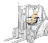
In considerazione dei rischi di patologia osteoarticolare dovuti all'esposizione a vibrazioni, i carrelli devono essere dotati di sedili che attenuino efficacemente le vibrazioni trasmesse al corpo. Inoltre il sedile sarà del tipo "ergonomico" ovvero regolabile nelle varie posizioni con/senza braccioli o conformato in modo tale da evitare lo scivolamento laterale del conducente nei cambi di direzione.
