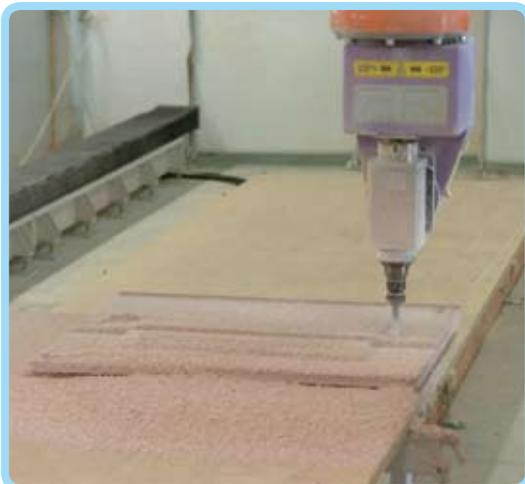
Figura 4: Fresatura a macchina: sgrossatura del modello.
