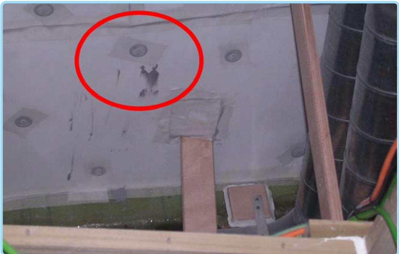
Figura 5: Coibentazione dell'imbarcazione: particolare della lana di vetro fissata con arpioni e rondelle e poi rifinita con nastro.
