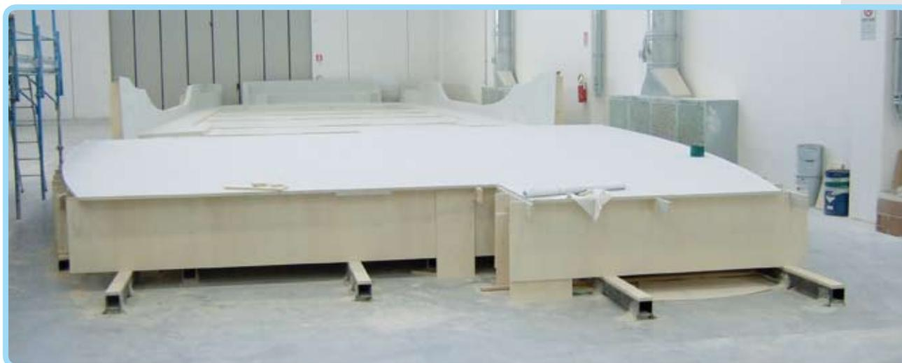
Figura 2: Modello in legno per la costruzione di una coperta.
