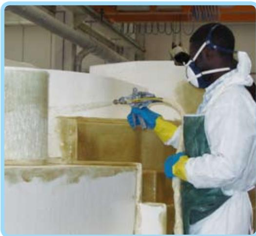
Nella fase di gelcoattatura, il modello viene rivestito con gelcoat tramite pistola a bassa pressione o manualmente. È necessario garantire in questa fase un elevato livello di finitura, poiché eventuali imperfezioni e segni di carteggiatura della superficie si evidenziano facilmente.
