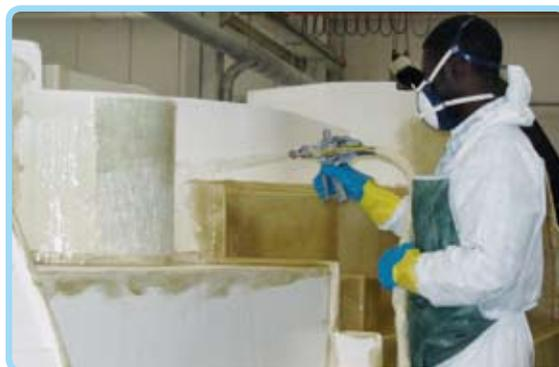
Figura 3: Operazione di resinatura a spruzzo.
