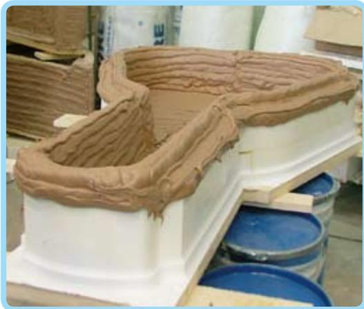
Per aumentare la rigidità del blocco, la superficie esterna viene rivestita con pasta epossidica o pasta poliuretanica (applicate con spatole o con macchina per estrusione) o con elastomero, (applicato con macchina a spruzzo ad alta pressione). I blocchi così rivestiti, vengono lasciati essiccare per circa 24 ore.
