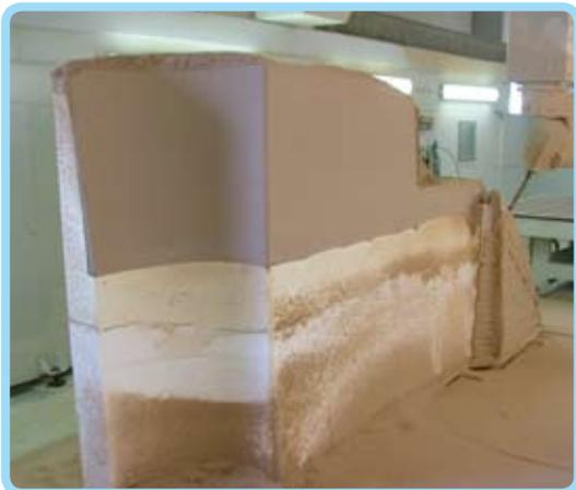
A seguito della polimerizzazione delle paste, si prosegue con la fresatura superficiale con adeguati utensili che permettono di ottenere una superficie liscia e uniforme. La superficie della struttura grezza viene rivestita con stucco poliestere e successivamente carteggiato e lucidato manualmente per avere una miglior finitura del modello.
