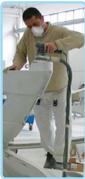
Vanno innanzitutto rilevate e rimosse le imperfezioni presenti sulle zone di giunzione. Per il taglio e la rifilatura vengono impiegati utensili portatili ad aria compressa o elettrici con dischi abrasivi o diamantati. Le zone di giunzione vengono molate in modo da eliminare totalmente il gelcoat ed eventuali sostanze non desiderate (es. cere) che renderebbero difficoltosa la successiva operazione di resinatura.
