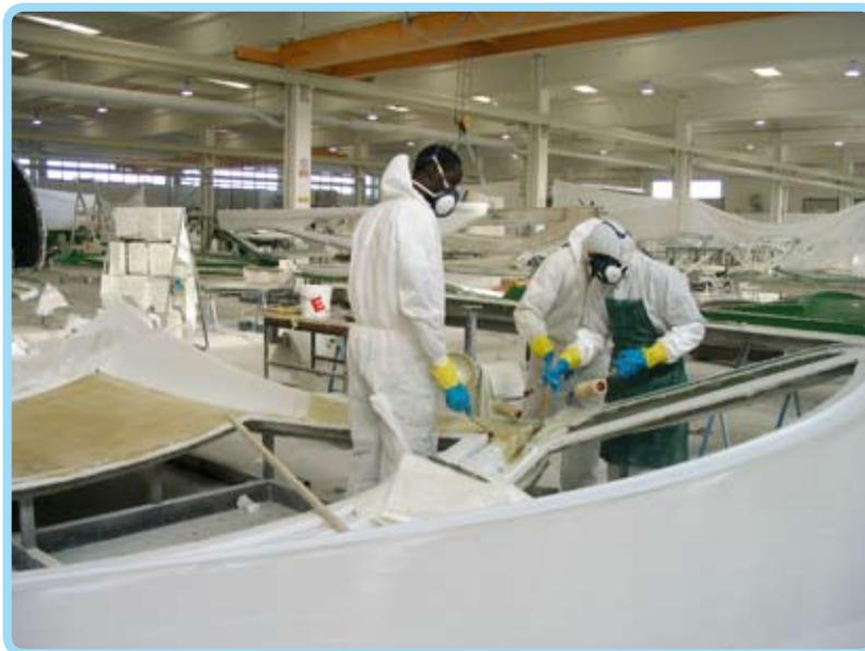
Figura 4: Stesura di teli di fibra di vetro mediante pennelli e rulli a manico corto.
