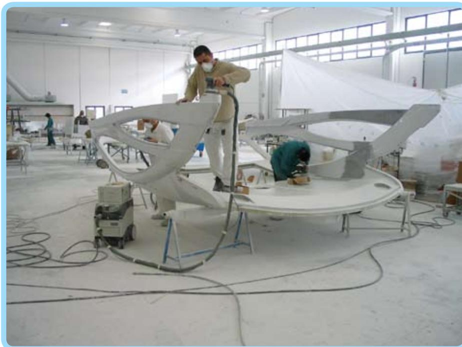
Figura 5: Fase di rifinitura in cui vengono adottate levigatrici orbitali, utensili che espongono a rumore e vibrazioni.
