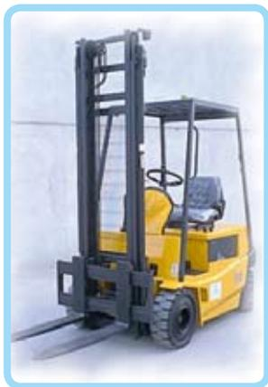
I carrelli elevatori sono macchine per il trasporto di merci che ospitano a bordo il conduttore; possono essere tipo elettrico (funzionano mediante motori elettrici alimentati da batterie) o con motore a combustione interna.
