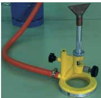
Esto se puede conseguir acoplando al mechero una pieza triangular llamada "mariposa" que tiene por objeto extender la llama o, si no se dispone de esta pieza, hay que ir deslizándolo al mismo tiempo que se gira lentamente para que la llama caliente una mayor longitud hasta que el tubo empieza a doblarse por su propio peso y la llama se colorea de amarillo por el sodio; entonces se saca de la llama y suavemente se dobla hasta conseguir el ángulo deseado.
