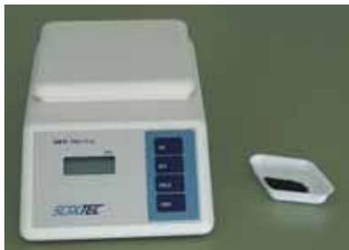
Para determinar masas de productos químicos se utiliza una balanza. Las sustancias no se depositan directamente sobre el plato de la balanza porque ésta podría estropearse. Se utiliza un pesasustancias como el de la foto. Se debe evitar cualquier perturbación que conduzca a un error, como vibraciones debidas a golpes, aparatos en funcionamiento, soplar sobre los platos de la balanza, etc.
