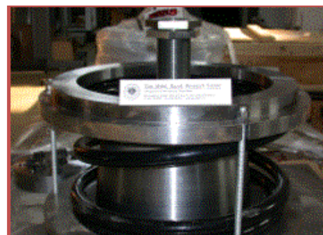
molla e sistema smorzante fluidodinamico
