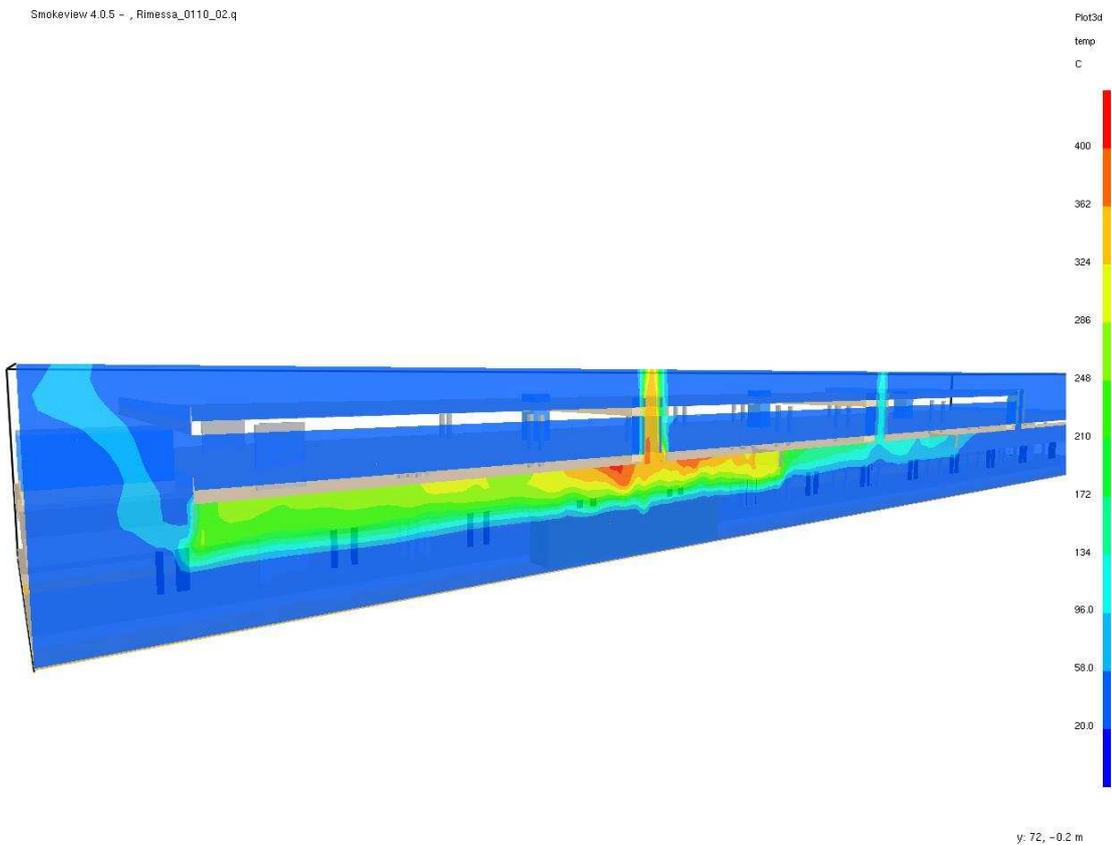
Simulazione preliminare (Incendio pre-impostato - Piano di temperatura)
