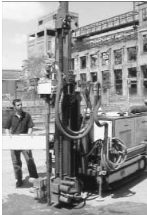
Figura 20: Attrezzatura utilizzata per l'esecuzione dei carotaggi
