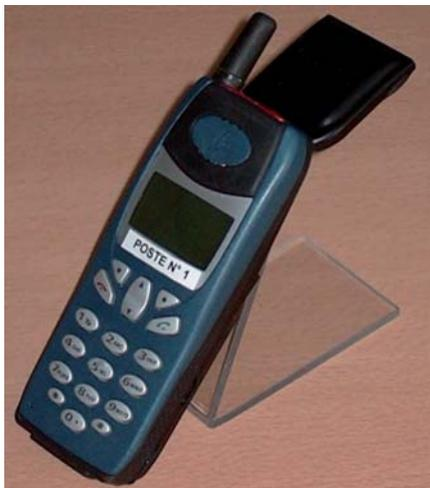
**Nouveau système DATI équipé d'une localisation GPS (l'antenne GPS est déployée sur le haut de l'équipement)**
