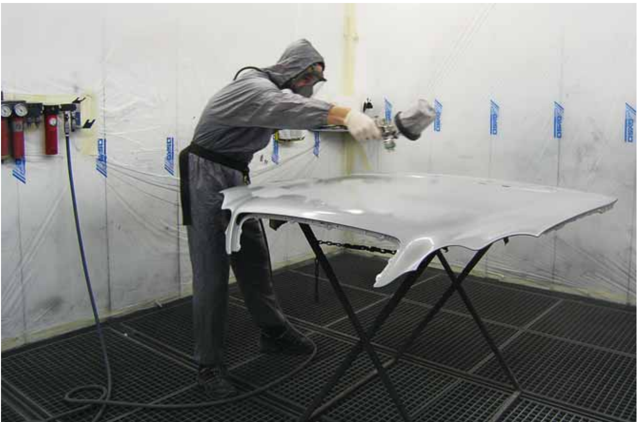
Fig. 6: operatore in una cabina di verniciatura. L'aspirazione avviene sotto il grigliato, mentre l'aria fresca viene immessa dall'alto.
